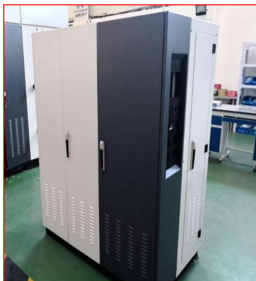
图 2 产氢 5 Nm 3 /h(3MPa) 制氢机
